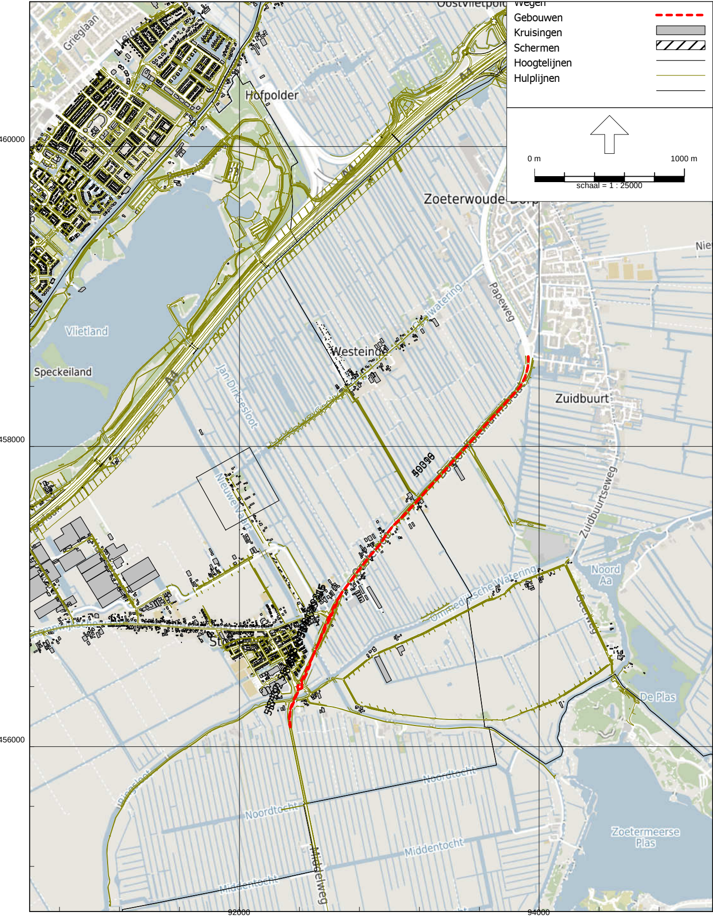
figuur 5b: Overzicht rekenmodel met ligging geluidbronnen - provinciale wegen -
