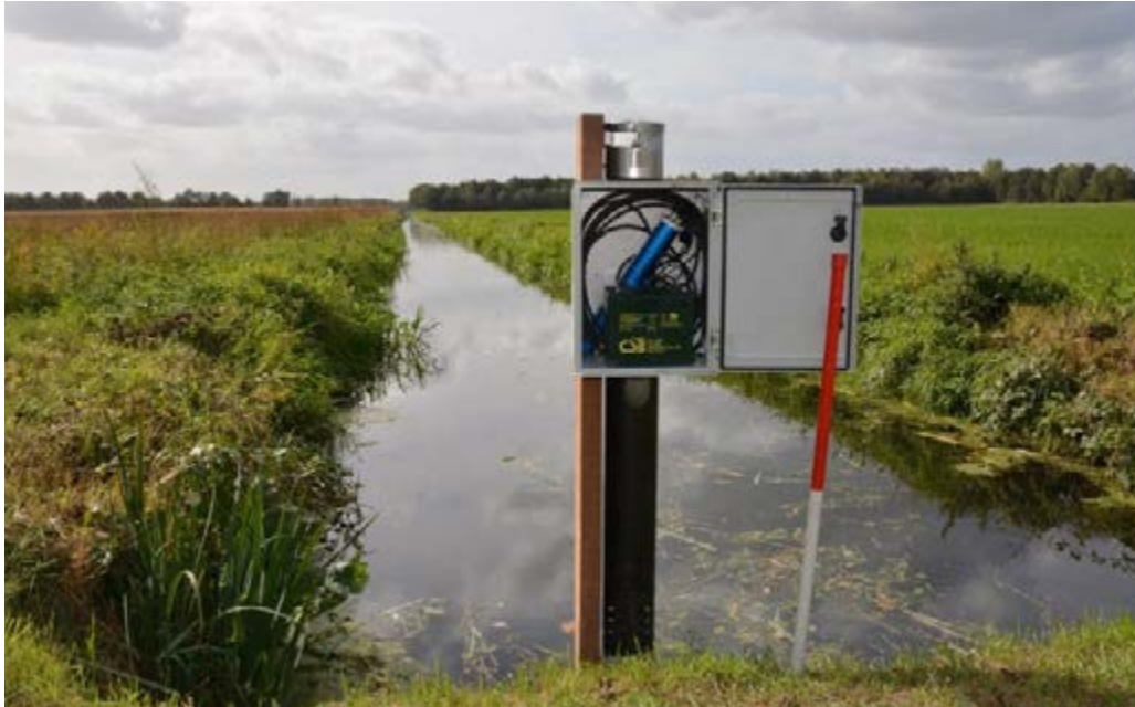
Om te bepalen welke maatregelen er nodig zijn wordt de kwaliteit van oppervlaktewater gemeten. Beeld: Pilot met online meten waterkwaliteit.
