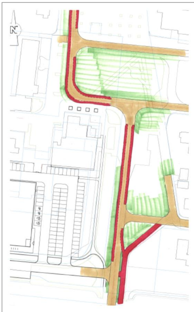
Afbeelding 12 | Vereenvoudiging verkeersstructuur Ingenieur Smedingplein
