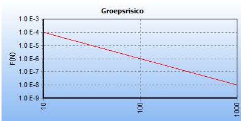
5.2 Figuur 5.2 FN curve voor 4817_leiding-W-574-05-deel-1 van N.V. Nederlandse Gasunie voor de kilometer tussen stationing 1160.00 en stationing 2160.00
