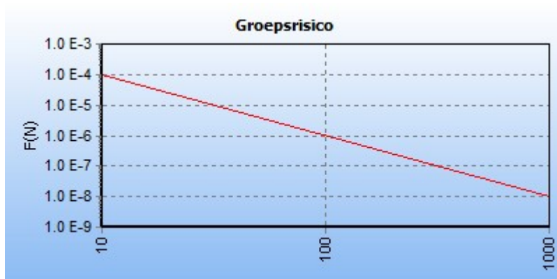
5.8 Figuur 5.8 FN curve voor 4740_leiding-W-574-14-deel-1 van N.V. Nederlandse Gasunie voor de kilometer tussen stationing 1090.00 en stationing 2090.00
