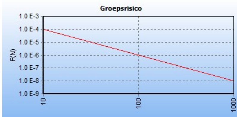
5.7 Figuur 5.7 FN curve voor 4740_leiding-W-574-01-deel-1 van N.V. Nederlandse Gasunie voor de kilometer tussen stationing 3340.00 en stationing 4340.00
