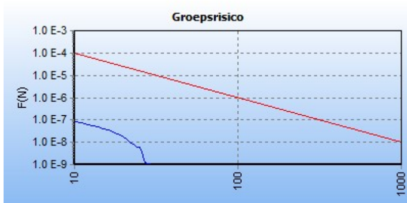
5.8 Figuur 5.8 FN curve voor 4740_leiding-W-574-14-deel-1 van N.V. Nederlandse Gasunie voor de kilometer tussen stationing 1090.00 en stationing 2090.00
