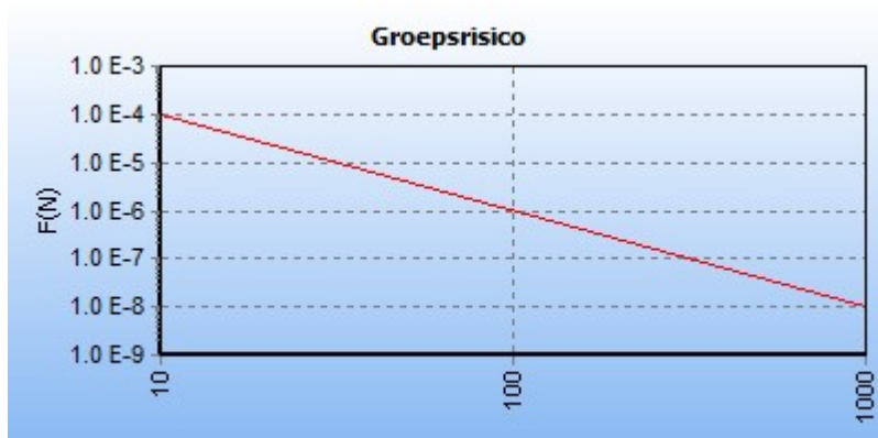
5.5 Figuur 5.5 FN curve voor 5599_leiding-W-574-14-deel-1 van N.V. Nederlandse Gasunie voor de kilometer tussen stationing 2760.00 en stationing 3760.00
