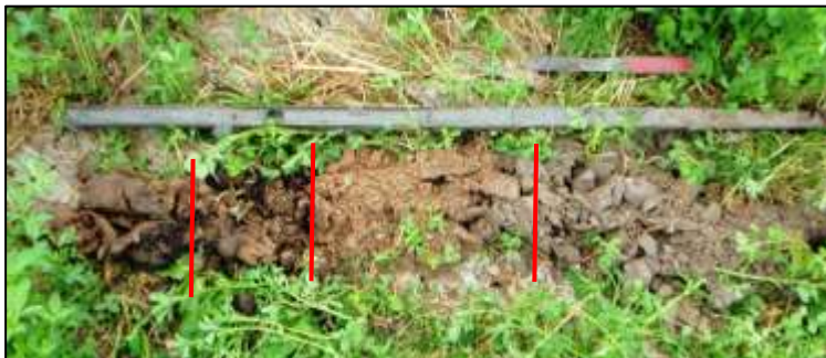
Afbeelding 2. Beeld van boring 2 met van rechtsonder naar links boven Zuiderzeeklei, sterk siltig zeer fijn zand van de Almere afzettingen, een laagje restveen met daaronder matig siltige klei met roestvlekken en slappe zwak zandige klei.
