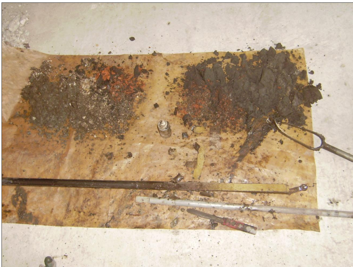
Afbeelding 3. Beeld van boring 2 met bovenin donkergrijs zand met baksteenpuin en onderin het gele keileem.
