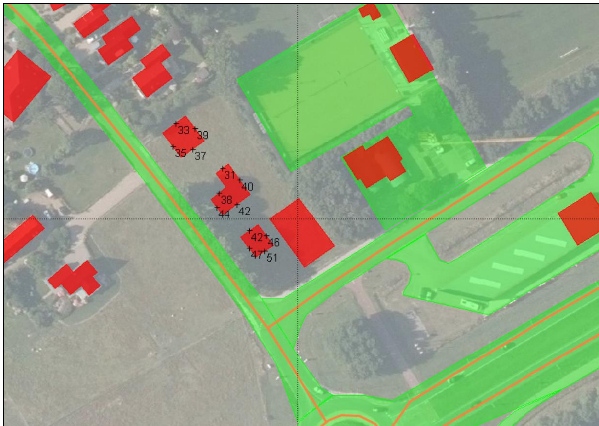
Figuur 5 Rekenresultaat waarneempunten, inclusief aftrek 5 dB conform artikel 110g Wgh.
