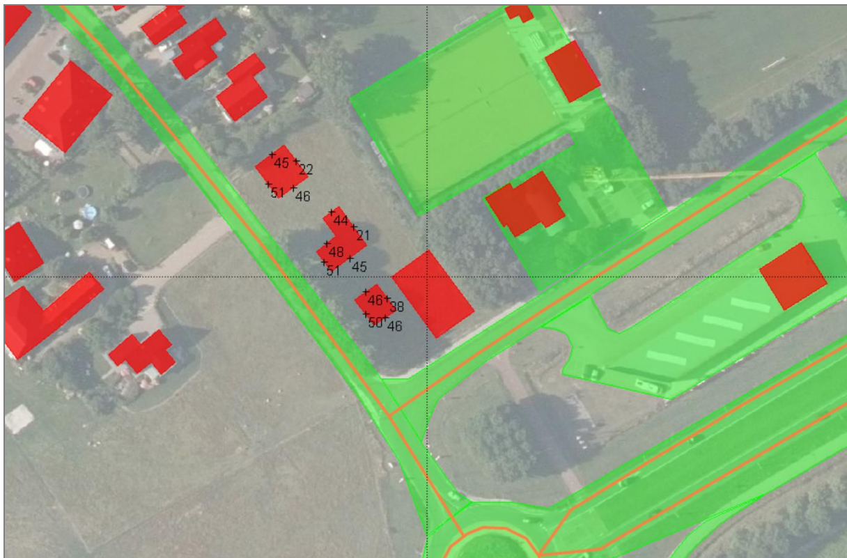
Figuur 6 Rekenresultaat waarneempunten, inclusief aftrek 5 dB conform artikel 110g Wgh.
