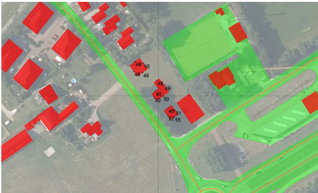
Figuur 4 Rekenresultaat waarneempunten, inclusief aftrek 2 dB conform artikel 110g Wgh.
