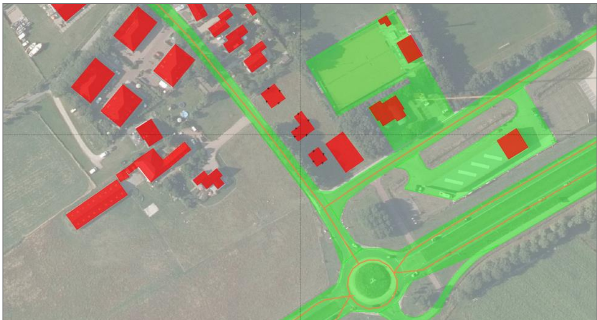
Figuur 3 Overzicht rekenmodel met de rijlijnen (oranje), absorptiegebieden (groen) en bebouwing (rode vlakken)
