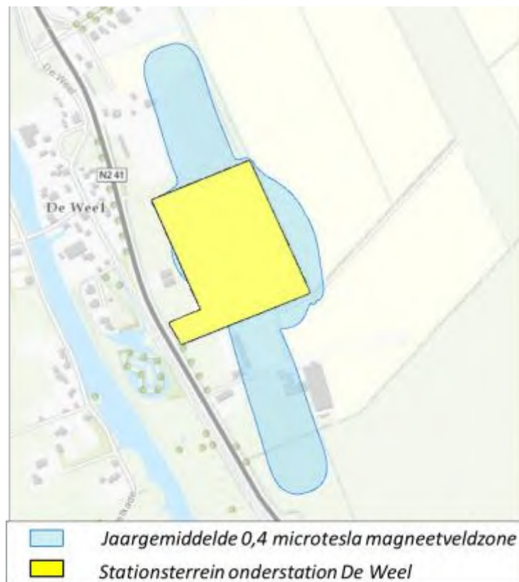
Figuur 5: Projectie jaargemiddelde 0,4 microtesla magneetveldzone van onderstation de Weel
