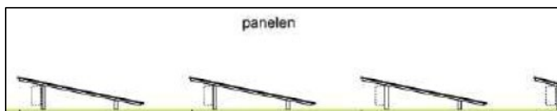
Figuur 4.18 Zijaanzicht van zonnepanelen in zuid-opstelling
