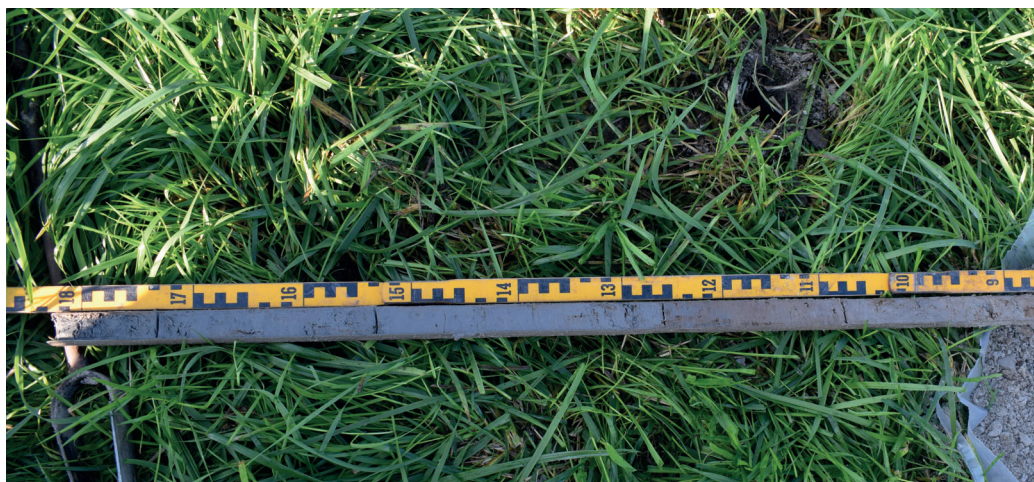
Afbeelding 4: Het onderste deel van boring 2. Hierin is duidelijk de oxidatiegrens in het zandpakket te zien vanaf 1,18 tot en met 1,26 meter -mv.
