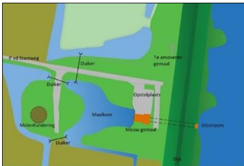
Afbeelding 2. Schets opzet nieuw gemaal met maalkom en duikers. Het huidige gemaal staat op de bovenste helft van de afbeelding.
