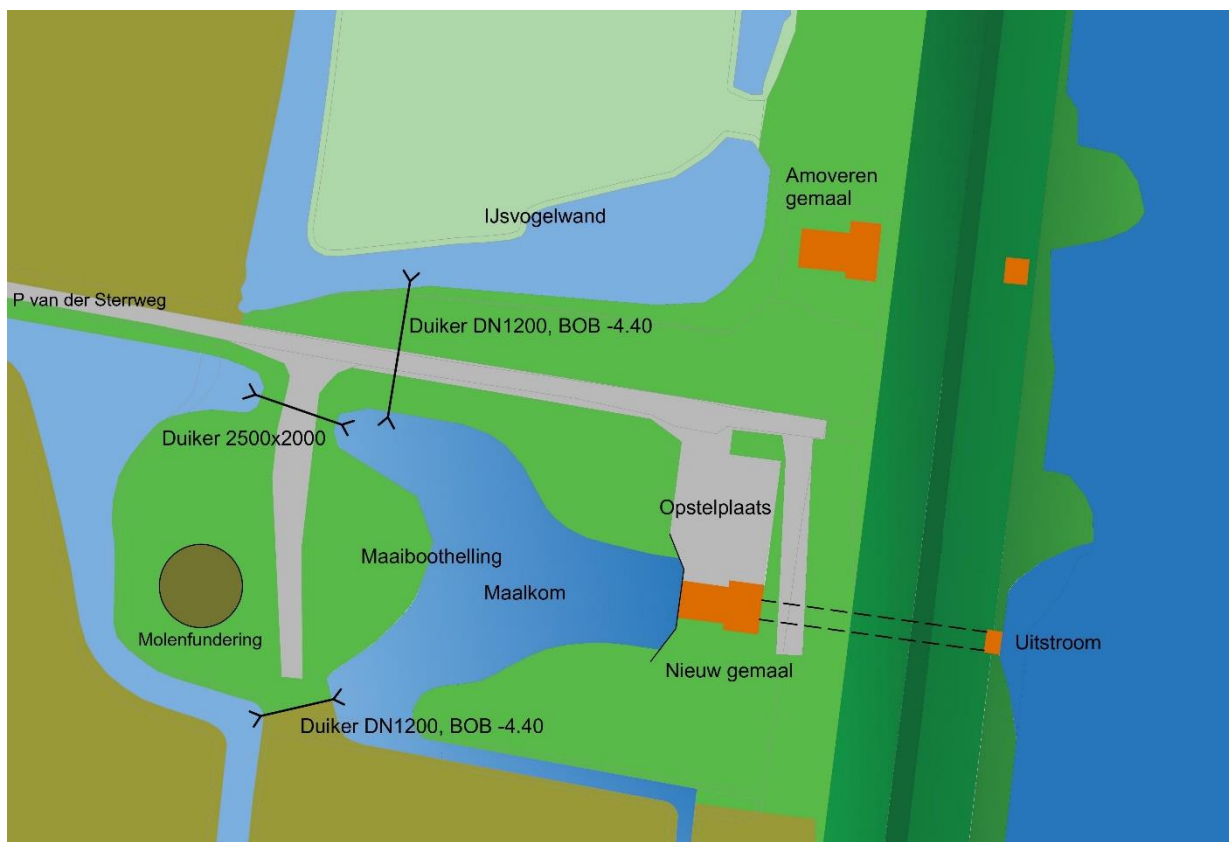
Figuur 4: Ruwe schets opzet nieuw gemaal met maalkom, duikers, behoud molenfundering. Ter oriëntatie: de P. v.d. Sterrweg en het huidige gemaal staan op de bovenste helft van de schets. De donkerste kleuren groen zijn eigendom HHNK, de lichtste kleur groen eigendom Landschap Noord-Holland.
