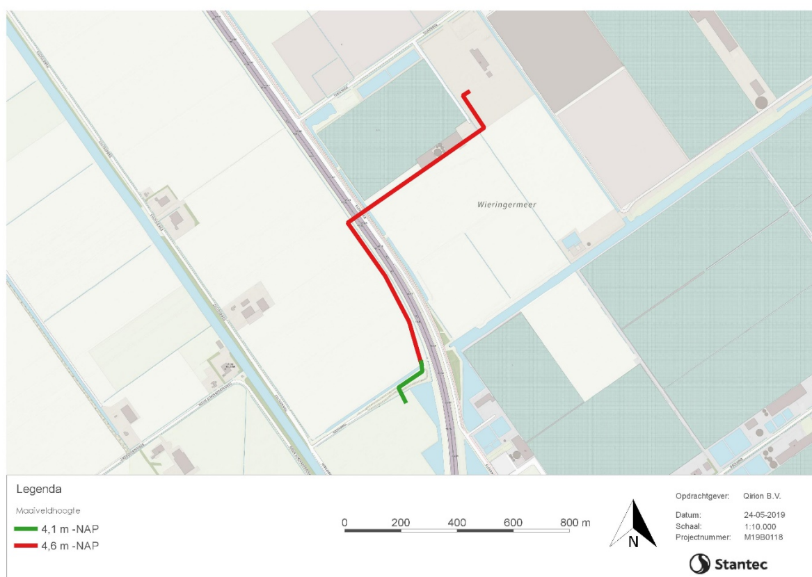
Figuur 2: Uitgangspunt maaiveldhoogte van het tracé
