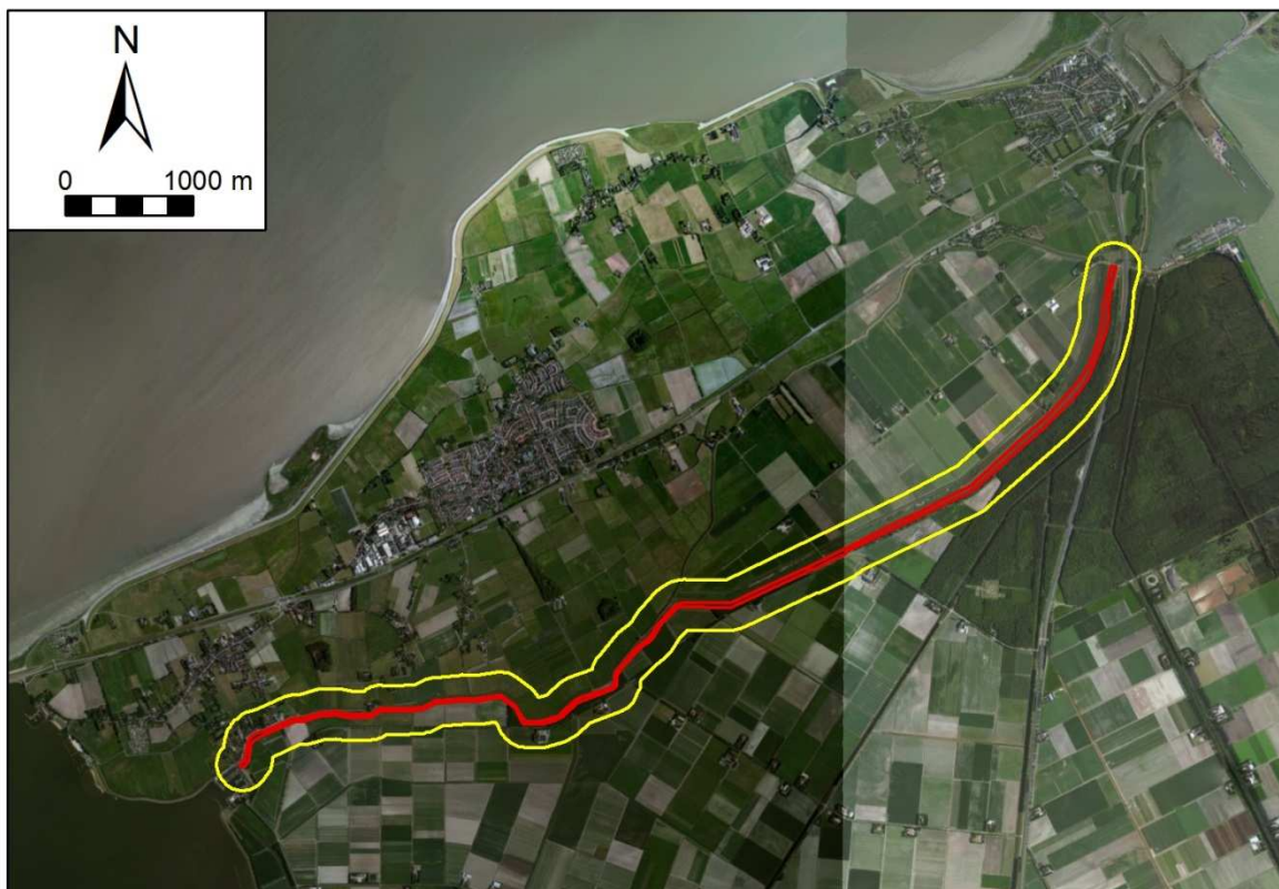
Figuur 1. Begrenzing werkgebied (rood) en onderzoeksgebied (geel). Ten behoeve van de analyse is voor de begrenzing van het onderzoeksgebied de in de WSCS-OCE maximale genoemde afstand voor de afbakening van verdacht gebied bij (duik)bombardementen gehanteerd, 181 meter.
