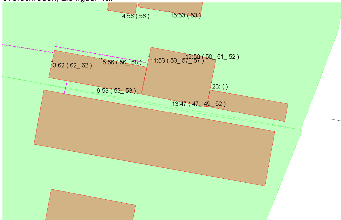
Figuur 4a: geluidbelasting vanwege Straatweg, incl. aftrek, hoogste waarde (waarde per waarneemhoogte tussen haakjes).
