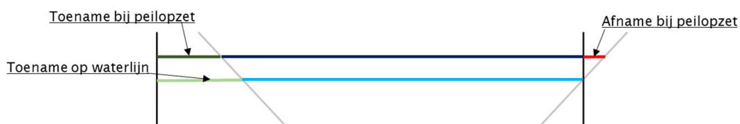
Figuur 2: Schematische weergave toename wateroppervlak op waterlijn en bij peilopzet
