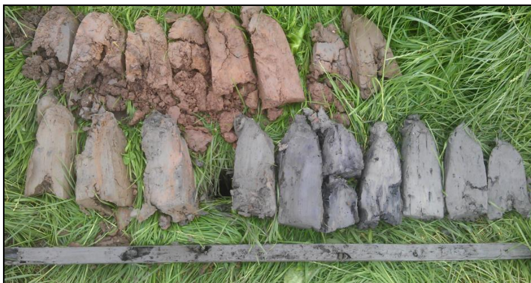
Figuur 8: boring 5 een matig siltig, matig planthoudend kleipakket als onderste pakket met daarboven een matig siltig, zwak zandig kleipakket met enige sporen roest. Hierboven twee lagen roesthoudende sterk siltige klei.
