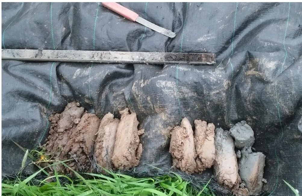
Figuur 7: Foto van boring 10. De top van het veen bevindt zich ter hoogte van het boormes.
