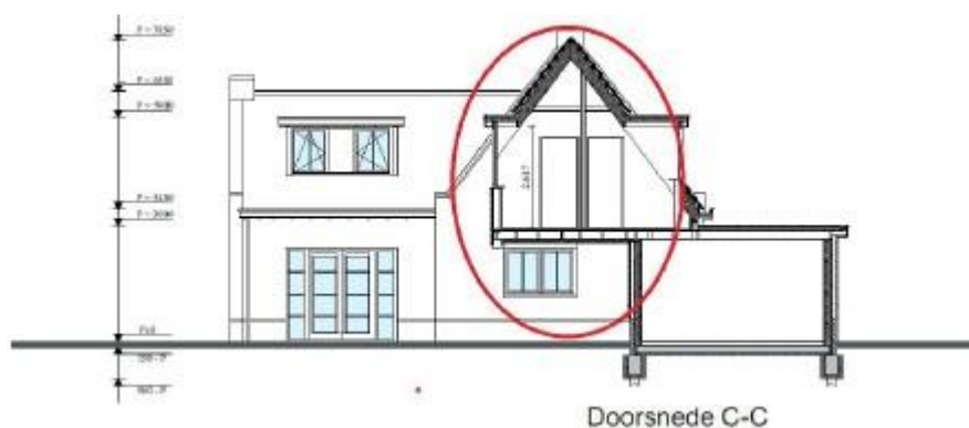
Doorsnede woning na uitbreiding op de verdieping
