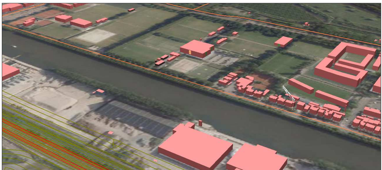
Figuur b11: Geluidbelasting railverkeer in 3D
