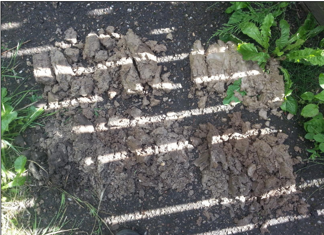
Figuur 7. Profiel van boring 3. Het erosieve pakket onder de bouwvoor is in deze boring niet aanwezig.
