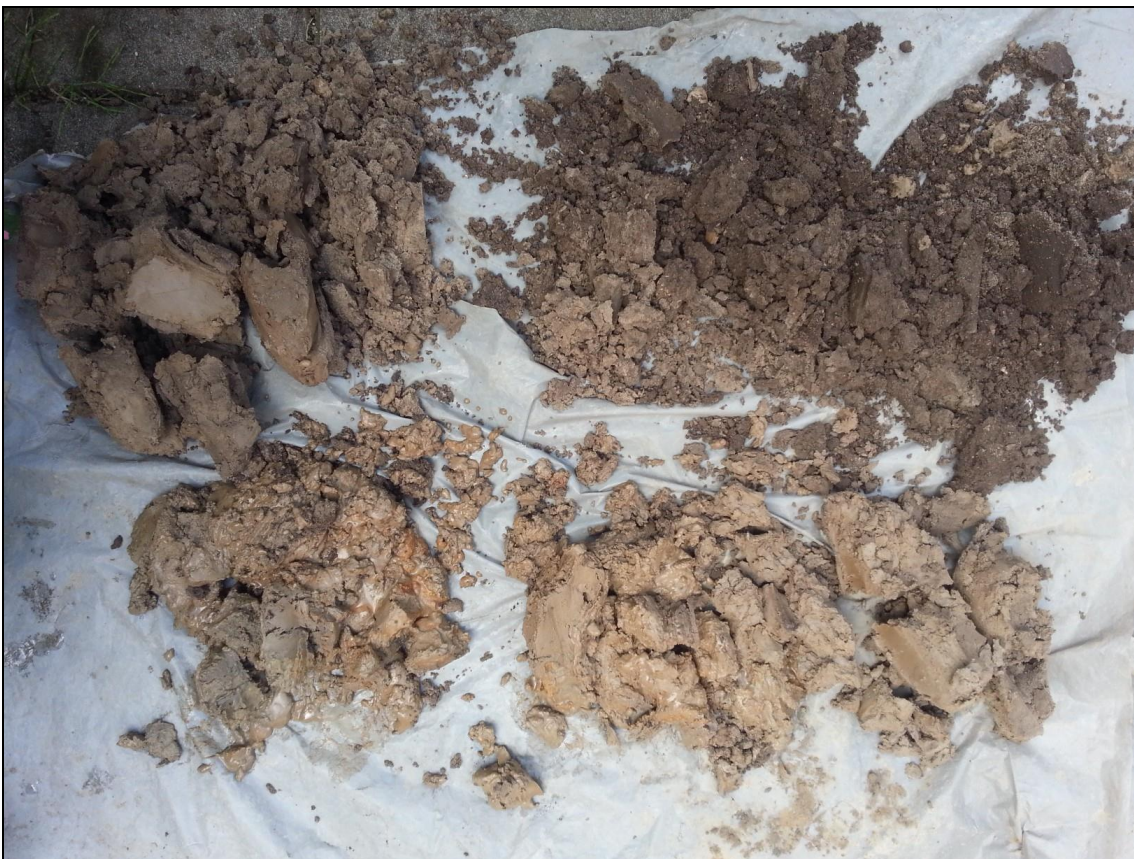
Figuur 8. Profiel van boring 5 waarop duidelijk de overgang is te zien van een erosieve laag (45-60 cm -mv) naar het kleipakket
