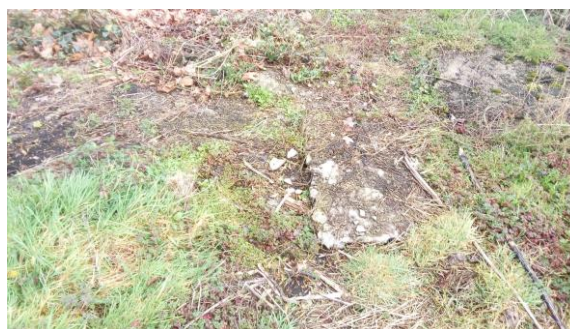
Foto 5: Op het beton nabij boring 09 is een stukje asbestverdacht materiaal gevonden.
