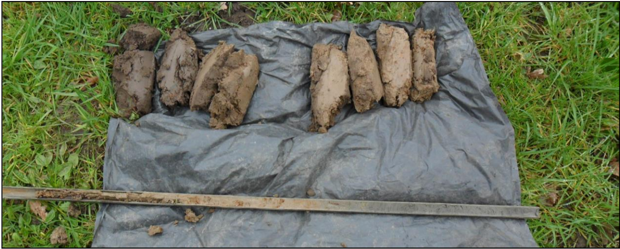
Opname van boring 2 tot een diepte van 2,0 m -Mv. Oeverafzettingen, die geleidelijk gereduceerd raken.
