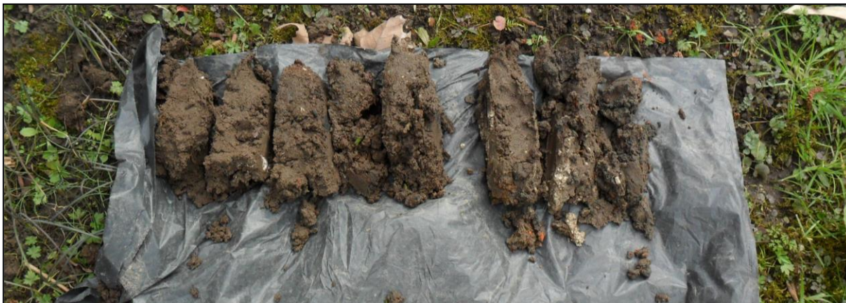
Opname van boring 8. Gestaakt in puin op 80-90 cm –Mv
