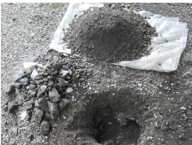
Afbeelding 3: foto asbestinspectiegat boorpunt 14
