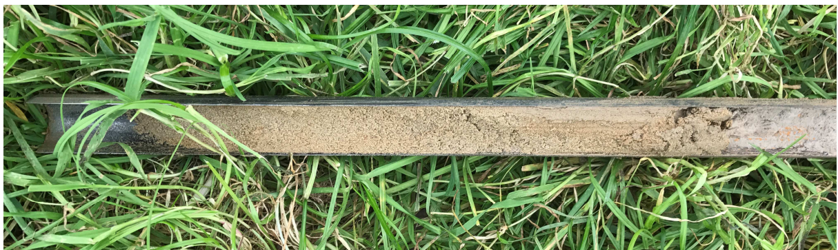
Opname van boring 1. De monsters boven (edelman) zijn per 50 cm uitgelegd en lezen van rechts naar links van boven naar beneden tot 130 cm –mv. De daaronder gefotografeerde guts betreft beddingzand tot een diepte van 2,0 m –Mv.
