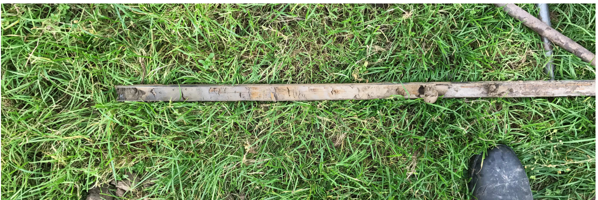
Opname van boring 5. Geulafzettingen van het traject 130 cm tot 200 cm. Het donkergrijze deel - linkerkant van de guts - betreffen gebande, zwak humeuze geulafzettingen.
