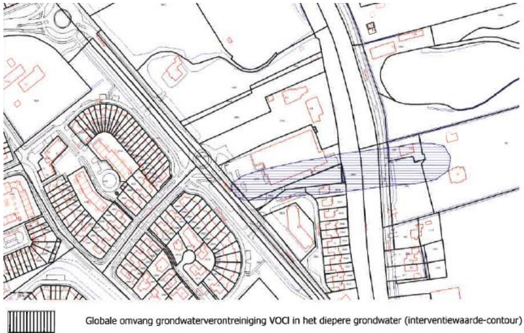
Figuur 2.9: Aangepaste contour verontreinigingsgeval 2 (grondwater)
