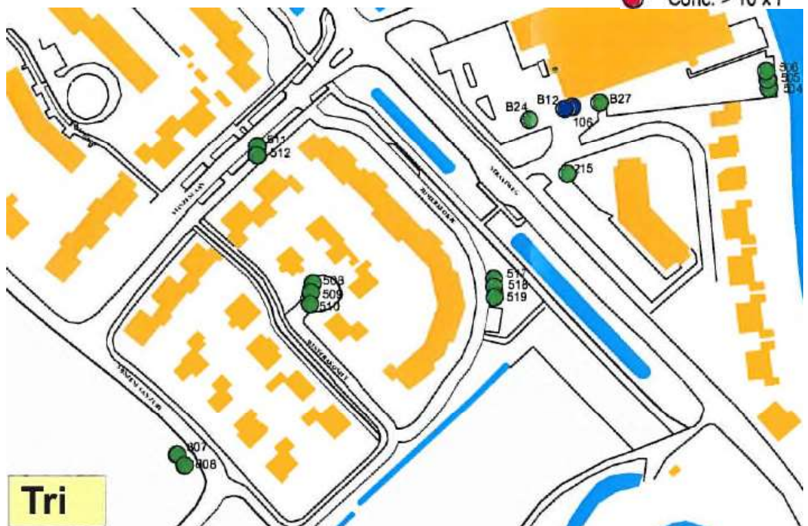
Figuur 4: Verontreinigingssituatie grondwater tri
