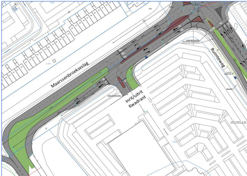
Figuur 5: Schetsontwerp aangepaste aansluiting Kwadrant op Maarssenbroekseslag
