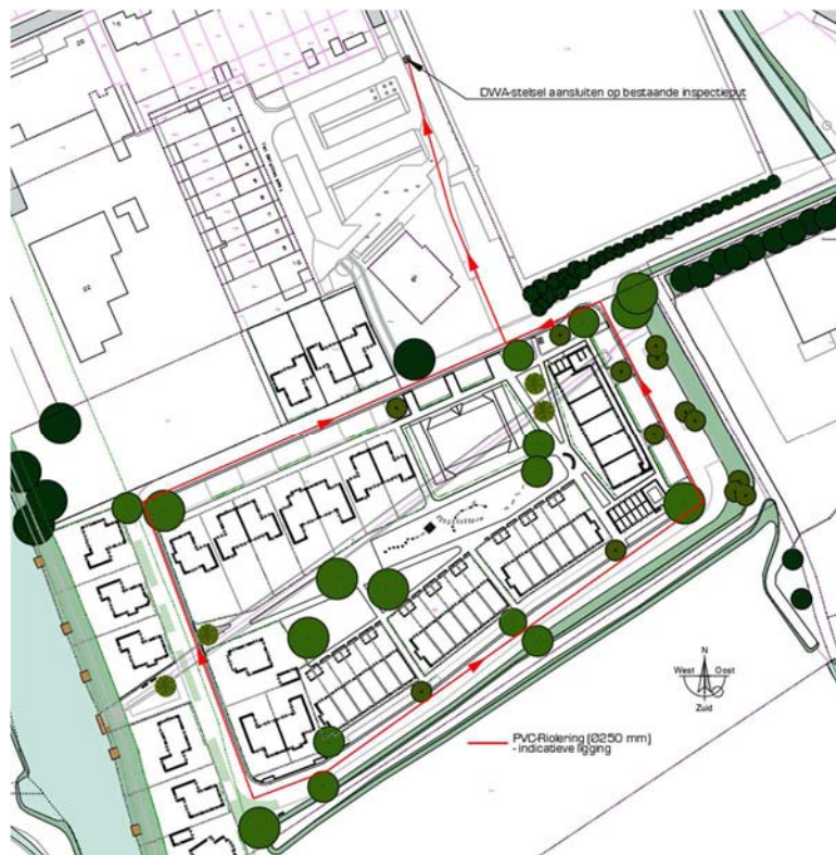
Figuur 10 - Voorstel vuilwaterstructuur
