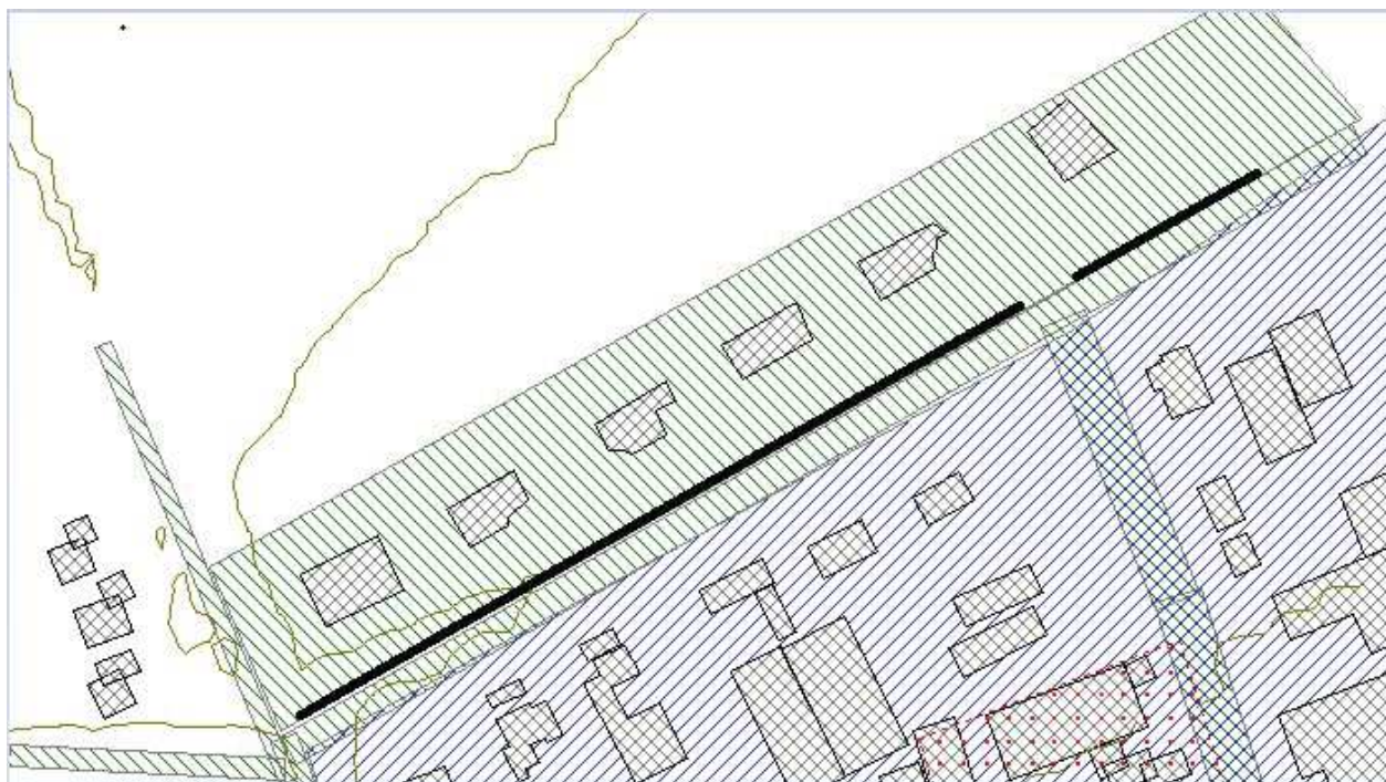
Figuur 6.1 weergave model met schematische weergave aarden wal ter plekke van nieuw te realiseren woningen.
