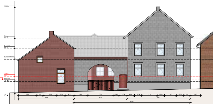
11 Voorgevel bestaande toestand Schaal 1 : 100
