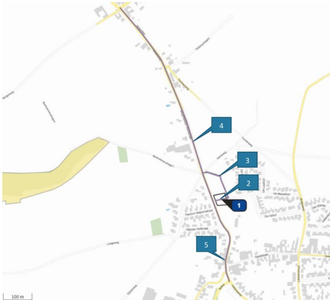
Figuur 3.1 gemodelleerde bronnen realisatiefase (de vlakbron is voor mobiele werktuigen en de lijnbronnen zijn voor het bijbehorende verkeer). Bron: AERIUS.
