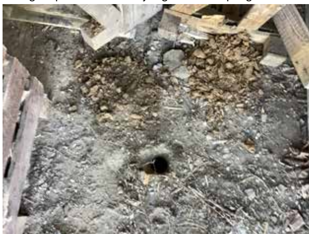
Foto 3 Boring voormalige olietank onder afdak
