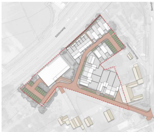
Figuur 1.8: Indicatie verharding en halfverharding in Bonfleur, Gronsveld
