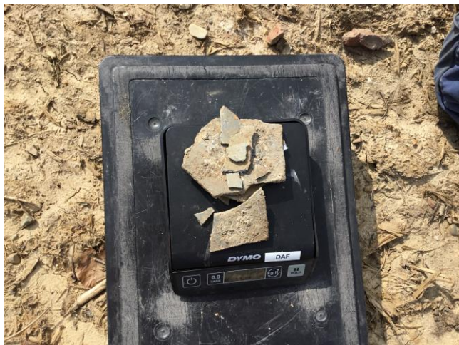
Asbest op maaiveld-5
