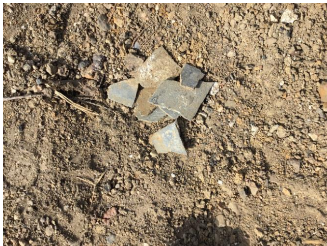
Asbest op maaiveld-6
