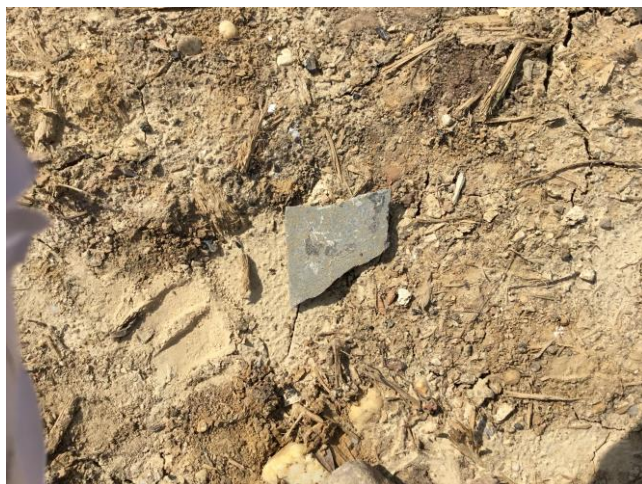
Asbest op maaiveld-2
