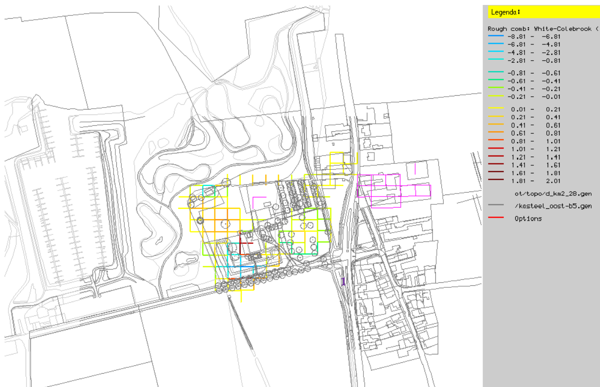
Figuur 8 Herontwikkeling Kasteel Oost, ruwheidsverschil (Nikuradse m), kas_b5 t.o.v. kas_a1
