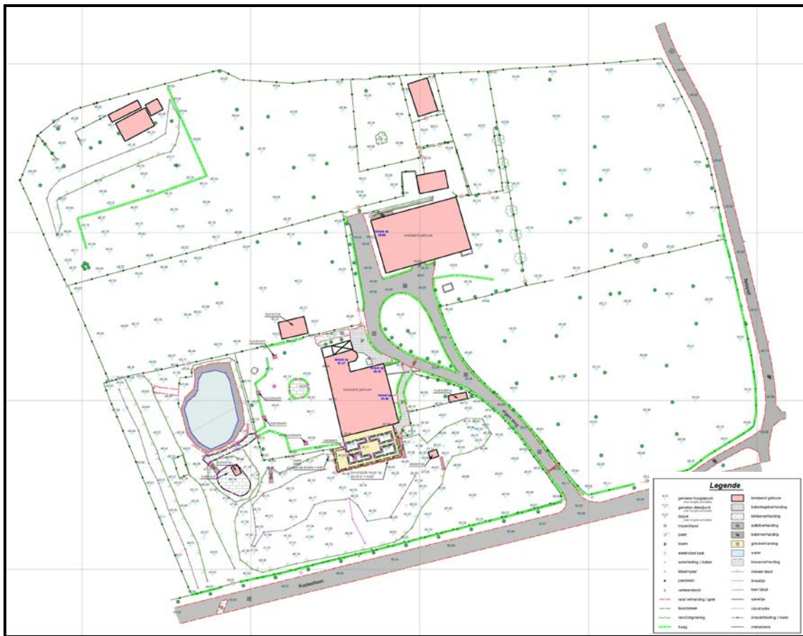
Figuur 2 Actualisatie van kasteel Oost, bodemhoogte, bebouwing en begroeiing (PS-Survey, 2014)
