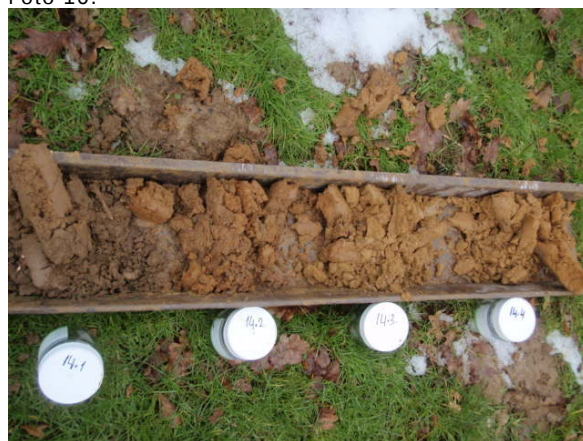
Foto 12: ter plaatse van boring 14 (bodemopbouw).
