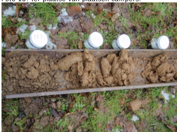
Foto 15: ter plaatse van boring 11 (bodemopbouw).
