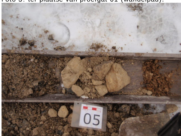
Foto 5: verhardingslaag met grind/ sintels.
