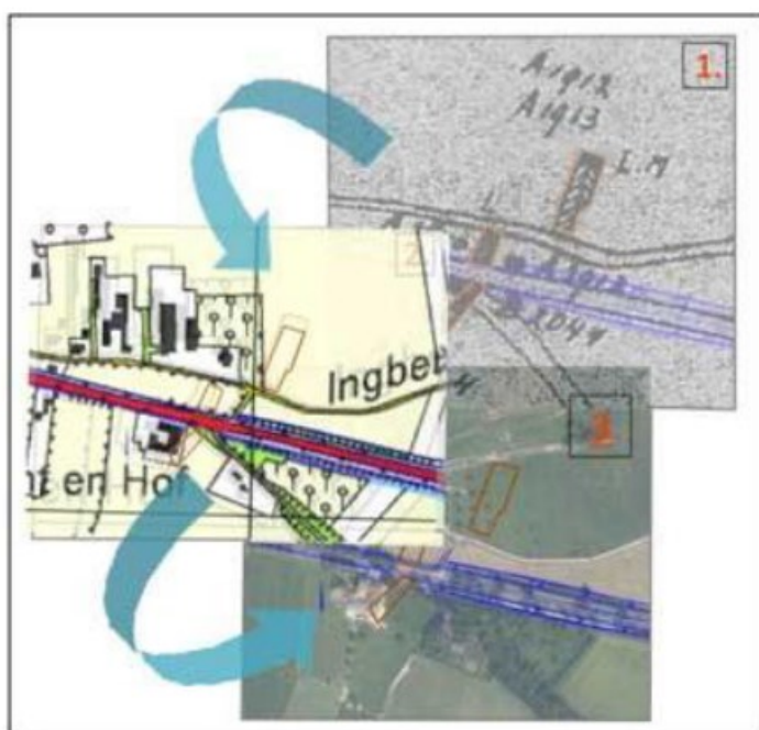
Fig. 26. Voorbeeld werkproces positioneren met een Geografisch Informatie Systeem. De kaarten met de stellingen zijn gepositioneerd op hedendaags kaartmateriaal en een WMS ondergrond. Bij het positioneren dient gezien de globaliteit van deze bronsoort rekening gehouden te worden met afwijkingen tot circa 10 meter.
