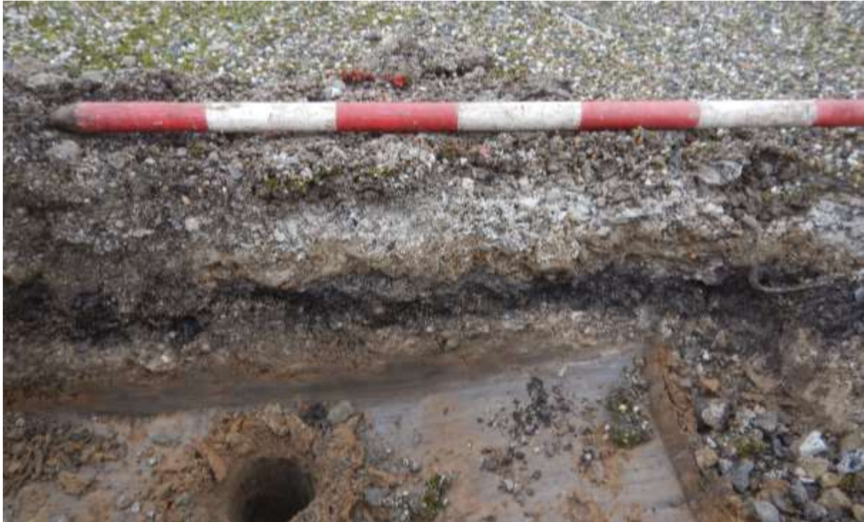
Figuur 16: Foto van boorlocatie 3, met een circa 20 cm dikke verhardingslaag op de oorspronkelijke leembodem.
