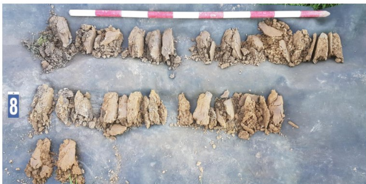
Figuur 33: Foto van edelmanboring 8, uitgelegd van linksboven naar rechtsonder.
