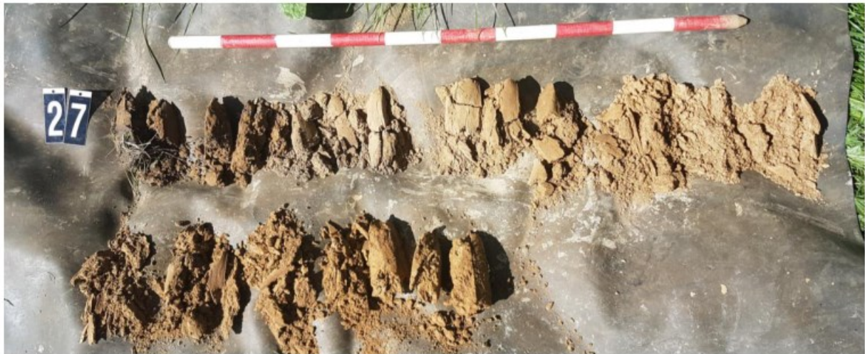
Figuur 29: Foto van edelmanboring 27, uitgelegd van linksboven naar rechtsonder.
