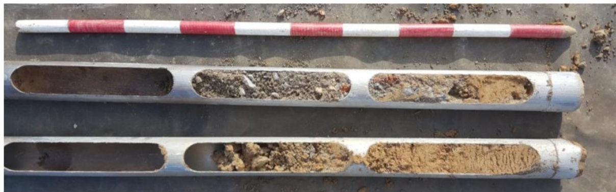
Figuur 26: Foto van ramgutsboring 24, uitgelegd van linksboven naar rechtsonder.
