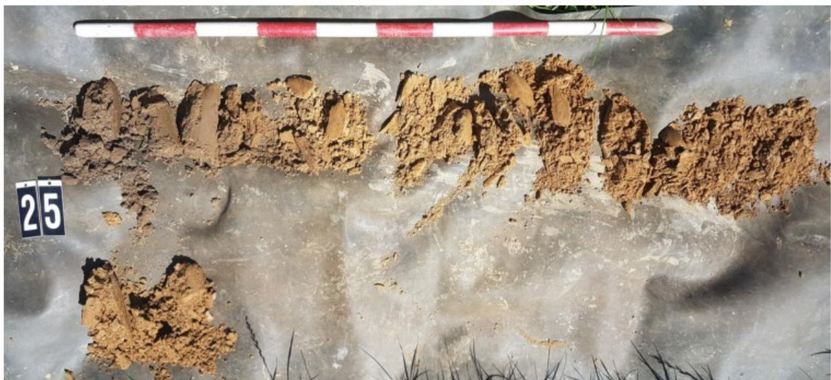
Figuur 30: Foto van edelmanboring 25, uitgelegd van linksboven naar rechtsonder.
