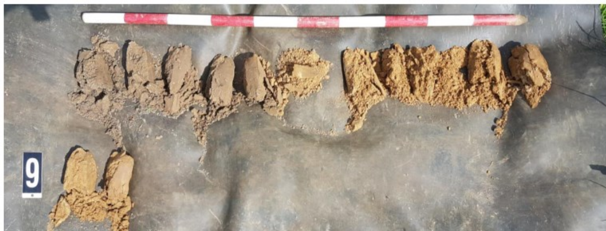
Figuur 32: Foto van edelmanboring 9, uitgelegd van linksboven naar rechtsonder.
