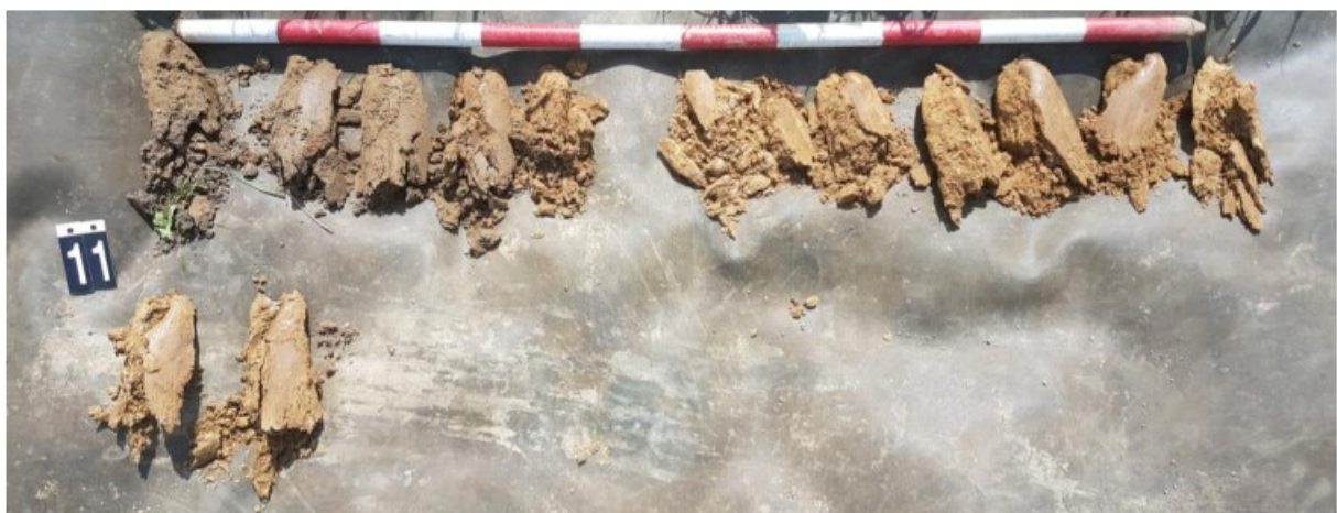
Figuur 31: Foto van edelmanboring 11, uitgelegd van linksboven naar rechtsonder.
