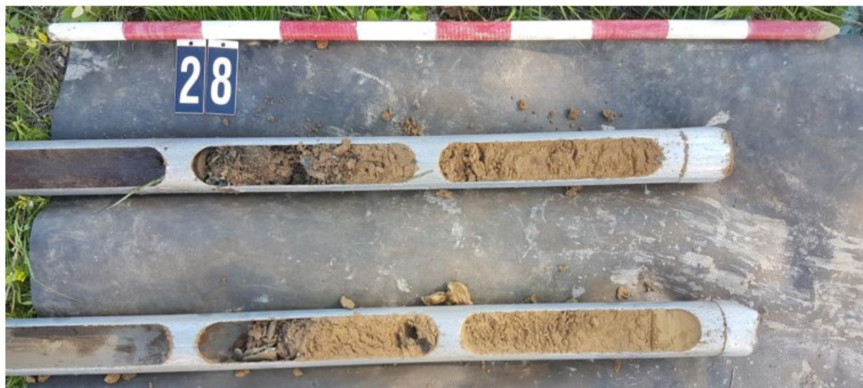
Figuur 28: Foto van ramgutsboring 28, uitgelegd van linksboven naar rechtsonder.
