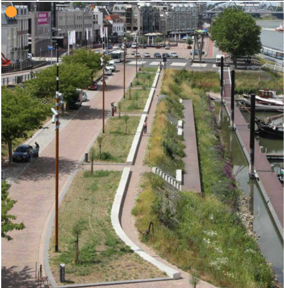
4m hoge verlichtingsmasten langs de kade 6m hoge verlichtingsmasten langs de rijbaan
