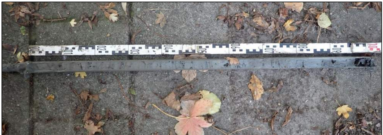
Afbeelding 16. Boorkern van boring 5, geulafzetting met vegetatiebandjes circa 3,5-2,5 m-mv.
