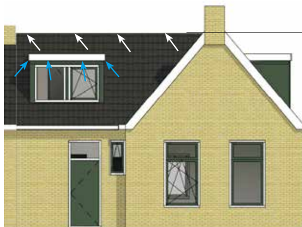
Figuur 3. Noordwestzijde: Invliegopeningen vleermuizen en huismussen in de nokpannen (witte pijlen) en voor vleermuizen in de dakkapellen (blauwe pijlen). Bron: Jelle's Boubedriuw Greonterp.
