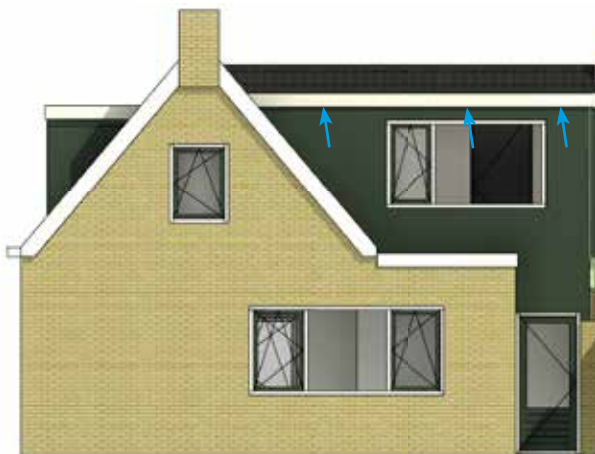
Figuur 2. Zuidoostzijde: Invliegopeningen voor vleermuizen in de boeidelen van de dakuitbouw (blauwe pijlen). Bron: Jelle's Boubedriuw Greonterp.
