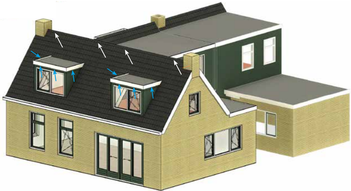
Figuur 1. Zuidwestzijde: Invliegopeningen vleermuizen en huismussen in de nokpannen (witte pijlen) en voor vleermuizen in de boeidelen van de dakkapellen (blauwe pijlen). Bron: Jelle's Boubedriuw Greonterp.
