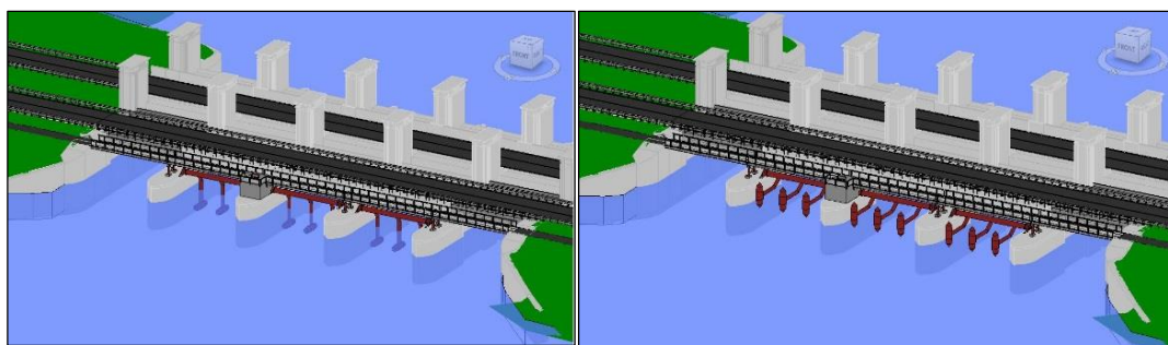
Figuur 2.6: Schetsontwerp getidenturbines (rechts in onderhoudsstand), Antea Group 2015
