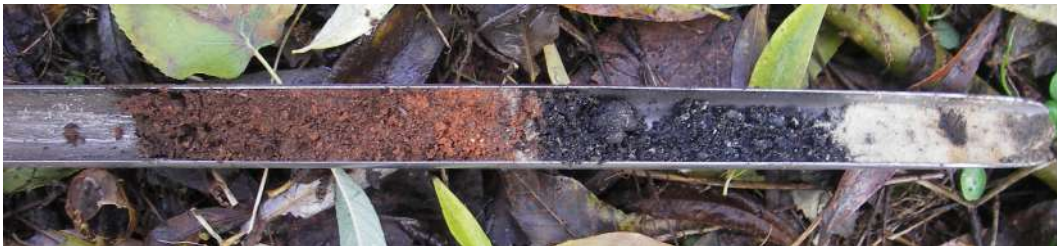
Figuur 5. Workum, Turflân 11. Foto van boring 2 met achtereenvolgens baksteengruis (oranje), slak (donkergrijs) en opgebracht zand (geel).
