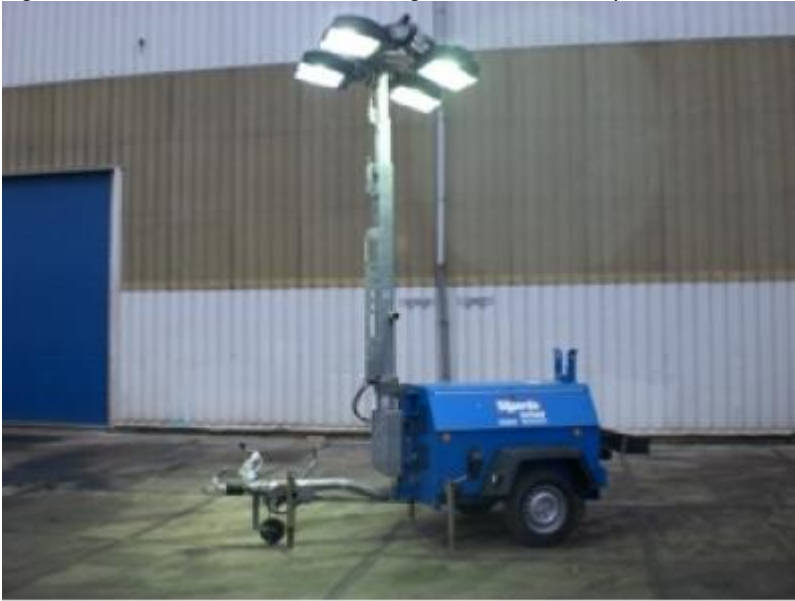
Figuur 3 Voorbeeld van bouwverlichting met richtbare lampen
