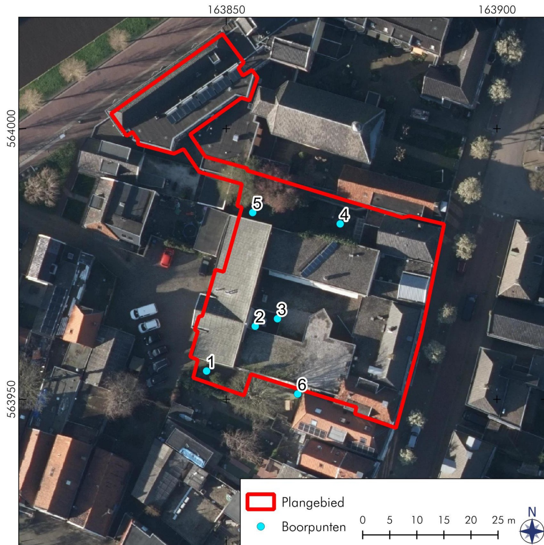
Figuur 12: Bolsward, Menniste Skill: Locatie van de boringen. De boringen zijn zo goed mogelijk verspreid over het terrein geplaatst. Binnen de bebouwing kon alleen in de binnenplaats worden geboord (boringen 2 en 3).
