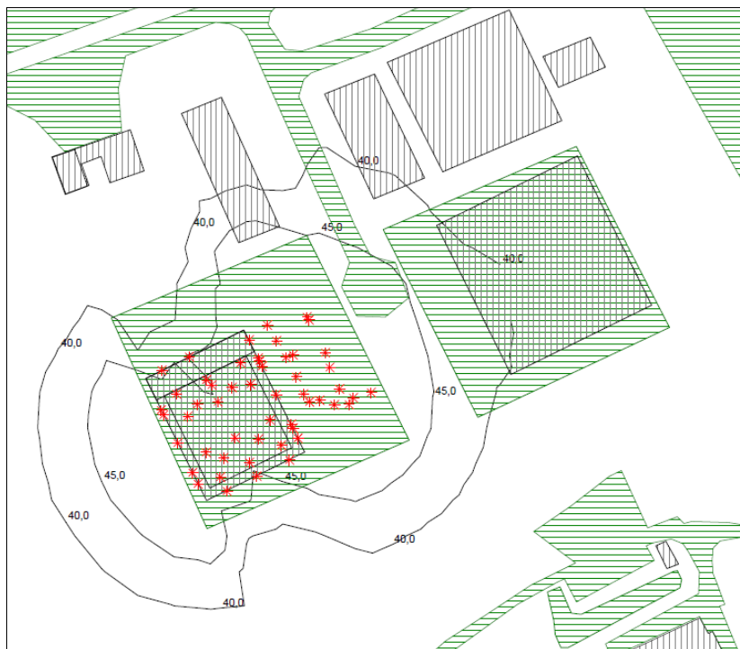
Figuur 2. Berekening geluidscontouren scheepswerf
